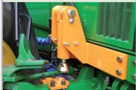
Kako bi se mogli apsorbirati torzijski momenti koji se javljaju duž uzdužne osovine vozila, na osovinsko kućište traktora ugrađuje se spojivi/odvojivi nosač blokade koji se može uključiti ili isključiti pomoću hidrauličkog cilindra. Ulje se dovodi do nosača blokade preko traktorskog hidrauličkog sustava. Ovisno o potrebi, nosač blokade se može postaviti na jednu ili na obje strane osovinskog kućišta.
