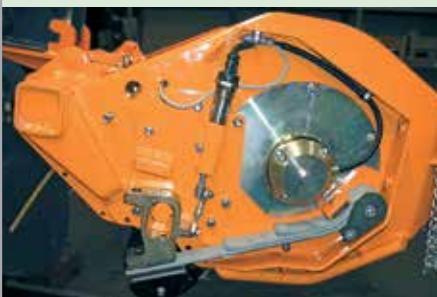
Potpuno automatska regulacija pritiska radne glave o površinu. Senzori prenose linije terena do središnje upravljačke jedinice koja automatski prilagođava funkcije kosilice.
