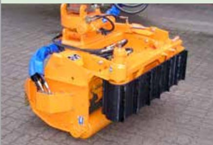
Kako bi se izbjeglo da pokošena trava ostane u dnu kanala i podno nasipa, radna glava može biti opremljena remenom za izbacivanje, za upotrebu u poslovima vodoprivrede. Remen za izbacivanje je podesiv i reverzibilan te može biti isporučen s funkcijom hidrauličkog preklapanja, po želji korisnika.
