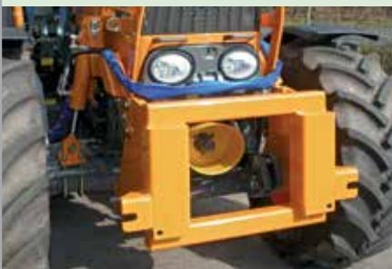
Za mehaničku ugradnju prednjih kosilica traktor mora biti opremljen prednjom prihvativom pločom (veličine 3). Prednja prihvativa ploča ugrađena je na prednje trotoče pri čemu se uklanjanju donje poluge prednjeg trotočja. To omogućava lak pristup i stabilnu podlogu za ugradnju prednje kosilice.
