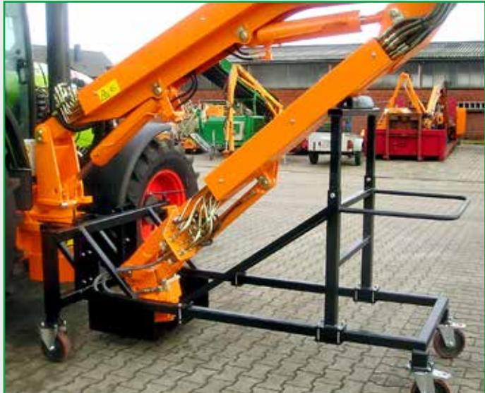
Uređaj se može lako ukloniti i odložiti pomoću transportnih kolica.
