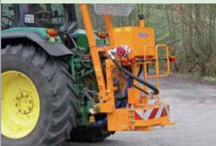
Za upravljanje kosilicama ugrađenim na prednju stranu vozila pomoću stražnjeg kardanskog vratila, na stražnju stranu vozila ugrađuje se hidraulički agregat. Jedna ili više hidrauličkih pumpi pokreće se jednim univerzalnim zglobovom. Istovremeno, potporni okvir aggregata nosi hidraulički spremnik, opcionalne protuutege i oslonac za transportni položaj kosilice.
