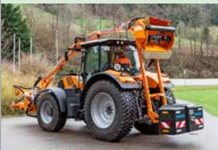
Transportni oslonac za kransku ruku i protuuteg mogu biti ugrađeni na stražnje trotoče. Oboje mogu biti uklonjeni i postavljeni zajedno. Za određene modele traktora, moguće je transportni oslonac pričvrstiti na nosač ljestvi.
