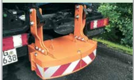
Zahvaljujući ovom modularnom sustavu smještenom na stražnjim nosačima D50, moguće je postići protutežu do 1800 kg dodavanjem ploča različitih težina.
