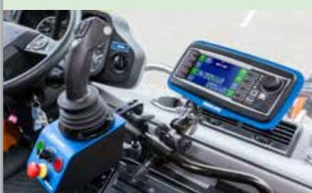
Upravljačka palica dizajnirana je na način da bude ergonomski – uskladena s oblikom ruke operatera. Do četiri proporcionalne funkcije mogu se kontrolirati na jednoj razini.
