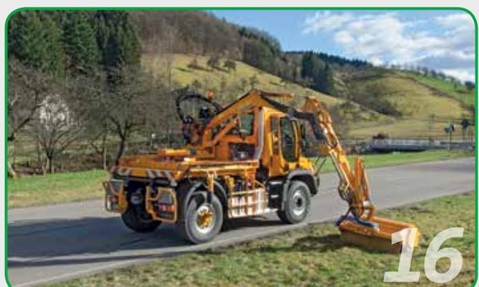
Stražnje kosilice učinkovito se ugrađuju na stražnji prostor Unimog vozila, s dosegom do 8.7 m.
