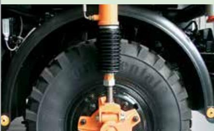
Operator može zaključati ovjes stražnje osovine preko upravljačke ploče iz kabine vozila. Ne mora izaći iz vozila što povećava sigurnost i udobnost u radu.
