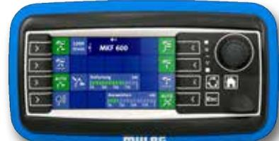
Zahvaljujući senzoru koji se nalazi direktno na ležaju, brzina rotora može se izmjeriti i prikazati na zaslonu. U slučaju da se prekorači maksimalna brzina, na zaslonu treperi signal upozorenja.
