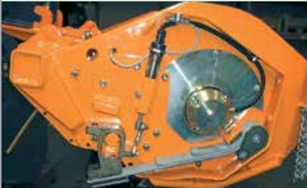
Potpuno automatska regulacija pritiska radne glave o površinu. Senzori prenose linije terena do središnje upravljačke jedinice koja automatski prilagođava funkcije kosilice.
