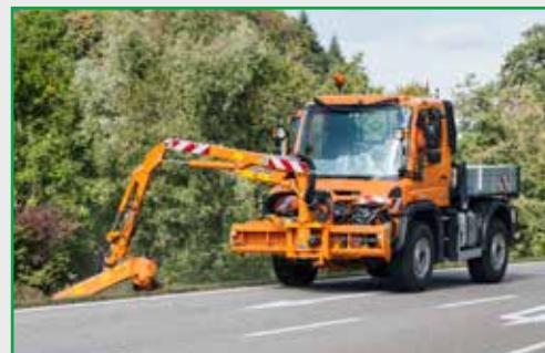
MFK 500, s dosegom do 7.0 m i bočnim pomakom u osnovnoj konfiguraciji, idealna je za korištenje na uskim cestama. U transportnom položaju, kranska ruka kosičice nalazi se na prednoj strani vozila i tako ostavlja dovoljno prostora za druge nadogradnje.
