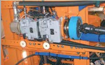
Stražnje kosilice mogu biti pogonjene putem pomoćnog pogona (kod N05). Zbog toga je hidraulički sustav kosilice potpuno neovisan o vozilu.
